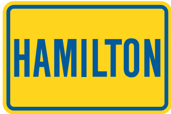
(d) M200 – DESTINATION Tab (used with QEW marker only)
