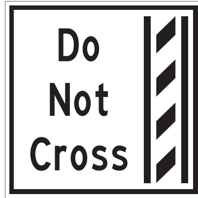
HOV – DO NOT CROSS RIGHT Sign (Overhead) (HOV-4R)
